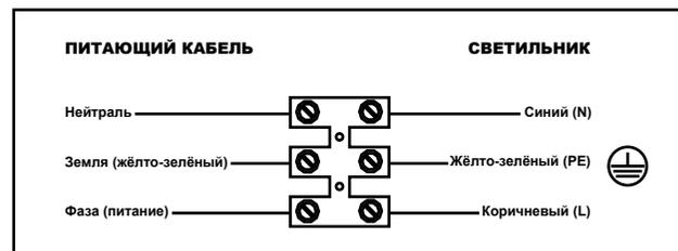
Имея правильно идентифицированные жилы питающего кабеля, осуществите их подключение к клеммному блоку светильника следующим образом.
