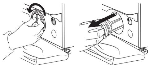
5. Очистите водяной фильтр: удалите остатки загрязняющих веществ, скопившиеся в фильтре, и промойте его под проточной водой.
