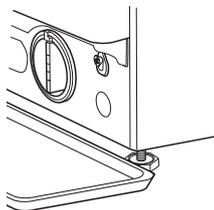
3. Слив воды: медленно поворачивайте фильтр против часовой стрелки до тех пор, пока не сольется вся вода. Дайте воде стечь, не снимая фильтр. После того как емкость заполнится, закройте фильтр, повернув его по часовой стрелке. Опорожните емкость. Повторяйте эту процедуру до тех пор, пока вся вода не будет слита.
