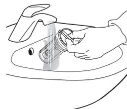
6. Установите на свои места водяной фильтр и цоколь: вставьте фильтр на место, повернув его по часовой стрелке. Убедитесь, что фильтр повернут до упора, при этом рукоятка фильтра должна быть в вертикальном положении. Для проверки герметичности фильтра залейте около 1 литра в дозатор моющего средства. Затем установите на место цоколь.
