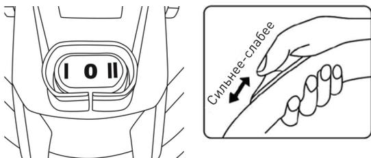
1) I - пылесос включен двигатель работает, пока не переведете переключатель режимов работы в нейтральное положение.
