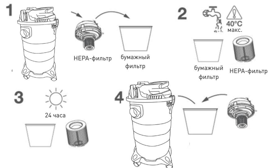
**ВНИМАНИЕ!** Чистку фильтров необходимо производить тщательно, иначе возможно ухудшение всасывания и повреждение двигателя.
