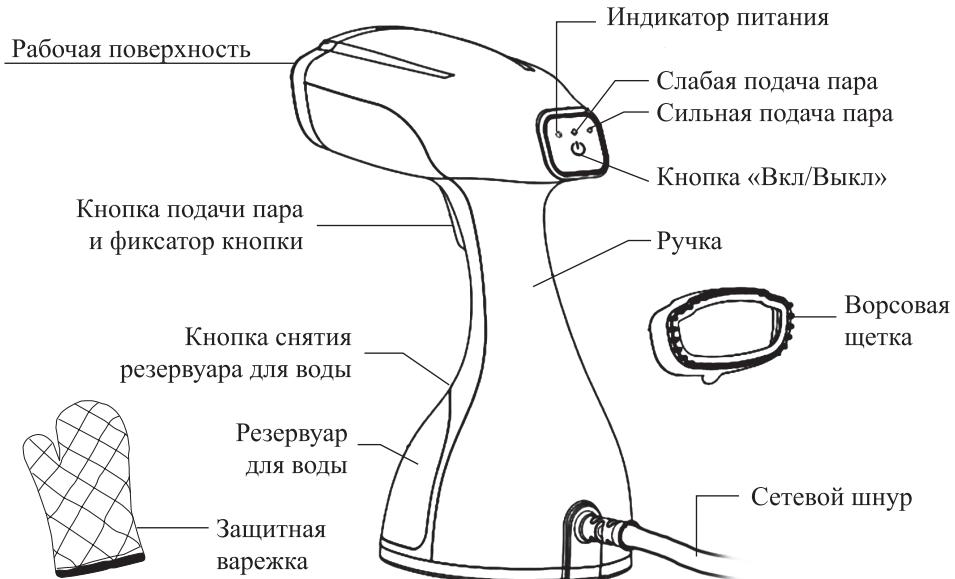
Резервуар для воды у отпаривателя съемный. Вода из резервуара подается в бойлер помпой (водяным насосом), где испаряется, пар выходит через паровые сопла на рабочей поверхности. Использование помпы позволяет точно дозировать количество подаваемой в бойлер воды и получать устойчивую подачу пара. Кнопкой «Вкл/Выкл» выберите режим слабой или сильной подачи пара, а также сухой гладжки. Когда индикатор питания горит непрерывно, значит устройство находится в режиме сухой гладжки и готово к работе.
