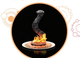
ВНИМАНИЕ: после проведения эксперимента дайте блюдцу остыть естественным образом. При резком перепаде температур, а также при охлаждении водой или другими веществами блюдце может лопнуть.
