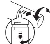
2. Установите алкалиновую (щелочную) батарею типа AAA таким образом, чтобы положительный (+) и отрицательный (-) контакты совпадали с полярностью, указанной в отсеке для элемента питания.
