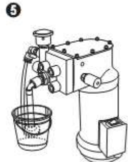
5. Сборка всасывания и обходная трубка в ведре с растворителем
