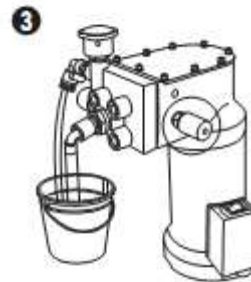
3. Поверните регулятор давления на HIGH (до упора по часовой стрелке)
