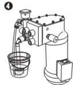
4. Трубка всасывания и обходная трубки остаются в ведре, их концы ниже уровня краски
