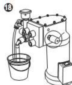
Поверните регулятор давления в положение LOW (до упора против часовой стрелки)
