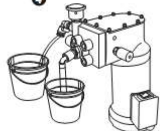
С регулятором prime/spray в положении PRIME, поверните регулятор давления на HIGH (до упора по часовой стрелке)
