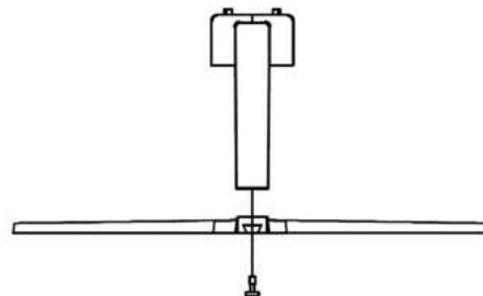
2. Положите монитор на ткань ЖК-панелью вниз, чтобы предотвратить повреждение ЖК-панели. Установите собранный корпус подставки в пазы монитора до характерного щелчка, как показано на рисунке ниже.
