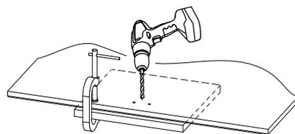
После сборки рекомендуем выставить по месту все столы, отрегулировать высоту с помощью опор, скрепить их межсекционной стяжкой (отверстие под стяжку сверлится самостоятельно сверлом Ø 5-6мм), затем закрепить столешницу отступив вперед от боковой стенки **50мм**, навесить фасады.
