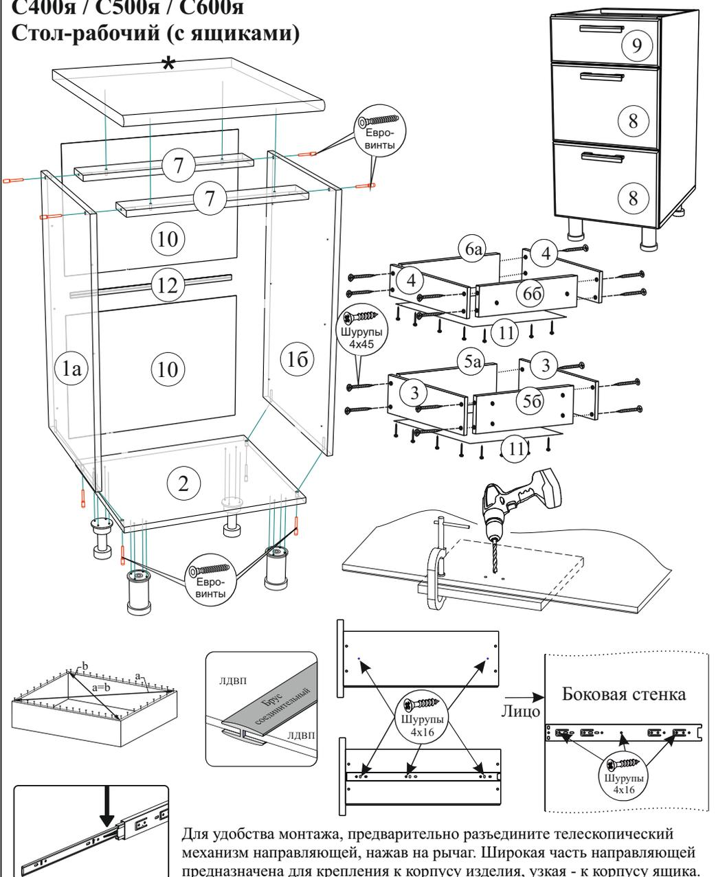
Для удобства монтажа, предварительно разъедините телескопический механизм направляющей, нажав на рычаг. Широкая часть направляющей предназначена для крепления к корпусу изделия, узкая - к корпусу ящика.
