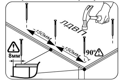
**!** Перед креплением ЛДВП гвоздями проверьте диагонали собранного каркаса!
