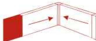
УДАЛЯЕМ ИЗЛИШКИ КЛЕЯ ПОСЛЕ НАНЕСЕНИЯ ПРОФИЛЯ
