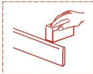
ПРОВЕРЯЕМ ТОЧНОСТЬ ПОДГОНКИ, ПРОТИРАЕМ ВЕТОШЬЮ
