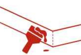
НАНОСИМ КЛЕЙ НА БОКОВОЙ КРАЙ УСТАНОВЛЕННОГО ПРОФИЛЯ,
