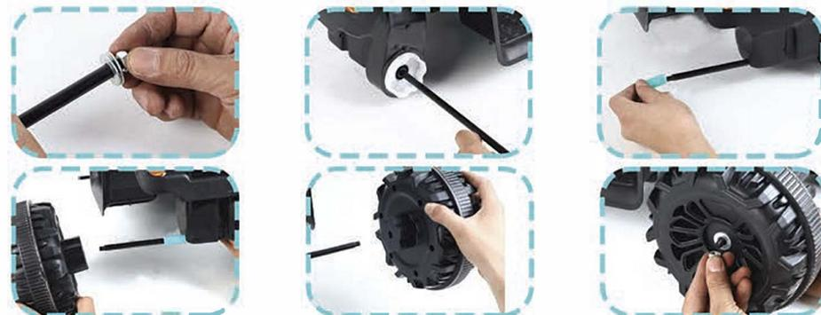
4. Установка задних колес. Снимите винты и прокладки с обеих сторон задней оси, пропустите заднюю ось через специальное отверстие в задней части кузова квадроцикла и наденьте пластиковые детали, установите по очереди левое и правое колеса, а затем установите прокладки и винты для крепления.
