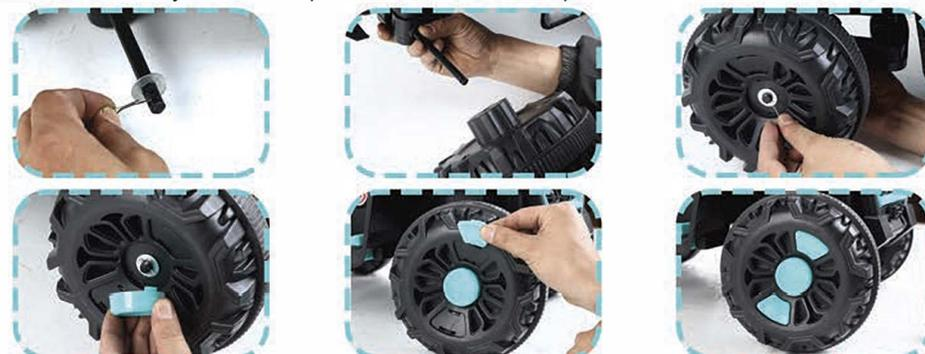
5. Установка передних колес. Снимите прокладки и штифты с обеих сторон передней оси, установите левое и правое передние колеса, а затем закрепите два вида колесных колпаков. Установка колес завершена.
