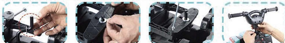
2. Снимите уплотнительную прокладку под рулевым валом, затем установите пластиковые детали и прокладки и зафиксируйте их с помощью штифтов и инструментов. Выровняйте руль над рулевым валом через зарезервированное отверстие.
