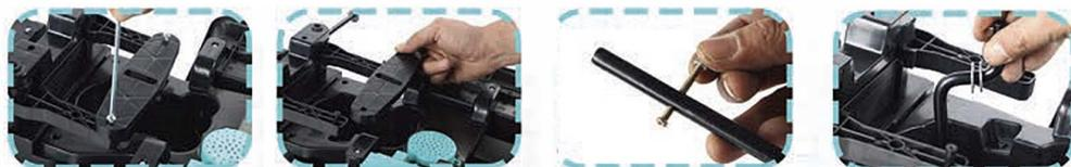
1. Установка руля. Сначала откручиваем два винта на пластиковой части под кузовом квадроцикла, снимаем пластиковую часть, а затем откручиваем винт над рулевым валом. Верхняя часть рулевого вала проходит через зарезервированное отверстие под кузовом квадроцикла.
