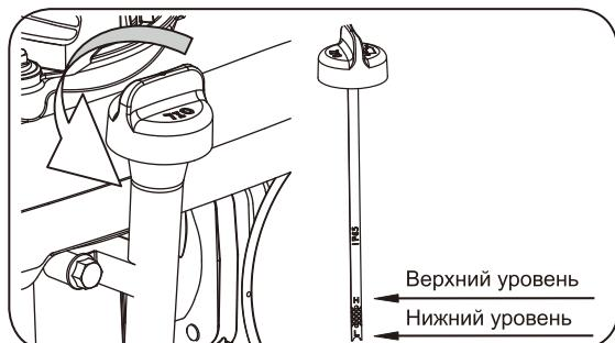
4. Установите на место крышку маслоналивной горловины и плотно затяните ее.
