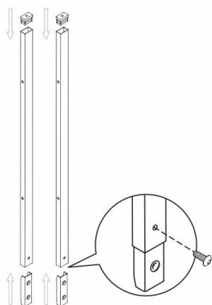
**2** СОЕДИНТЕ БОЛЬШИЕ И П-ОБРАЗНЫЕ СТОЙКИ, ЗАКРЕПИТЕ ИХ ВИНТАМИ **M5X12**.
