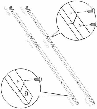
**2** СОЕДИНЯЙТЕ ПОЛУЧИВШИЕСЯ ДЛЯННЫЕ СТОЙКИ С П-ОБРАЗНЫМИ И ЗАКРЕПИТЕ ИХ ВИНТАМИ **M5x12**.
