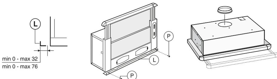
При таком способе монтажа необходимо приобрести гибкий несгораемый воздуховод (в комплект поставки не входит), соответствующий действующим нормативам, и надеть один конец гибкого воздуховода на переходной конец прилагающегося фланца. Место стыковки переходного фланца с воздуховодом смазать герметиком, а сам воздуховод закрепить на переходном фланце с помощью хомута (в комплект поставки не входит). Второй конец гибкого воздуховода соедините с вентиляционным отверстием.
