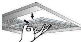
**Угольные фильтры** (если они установлены и вытяжка работает в режиме рециркуляции) следует периодически менять. Частота замены зависит от интенсивности использования, в среднем, примерно, один раз в полгода. Они устанавливаются на защитные решетки корпуса мотора путем легкого поджатия и поворота их по часовой стрелке. Для снятия угольного фильтра, его следует слегка поджать и повернуть против часовой стрелки (см. рис. ниже).
