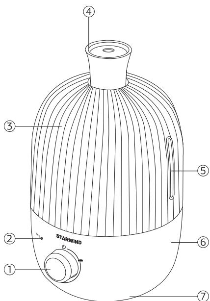
1. Поворотное реле включения/регулирования скорости испарения/выключения
