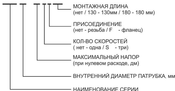
1 - 230v - однофазный мотор / 3 - 400v - трехфазный мотор
