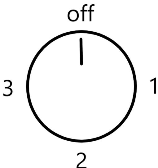
Для включения конфорок поверните ручку по часовой стрелке в нужное положение.
