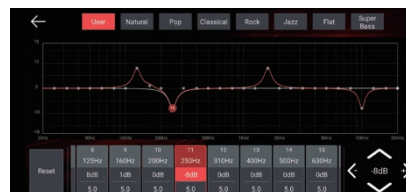
Выбор предустановок или настройка 30-полосного параметрического эквалайзера.
