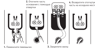
Рис.1. 230В шамчыракты токко туташтыруу схемасы
