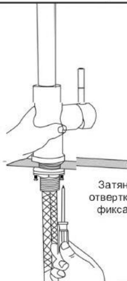
Затяните отверткой до фиксации
