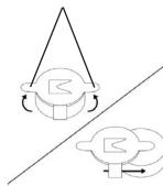
4. Установите монитор в корпус прибора, аккуратно надавив на него до фиксации.
