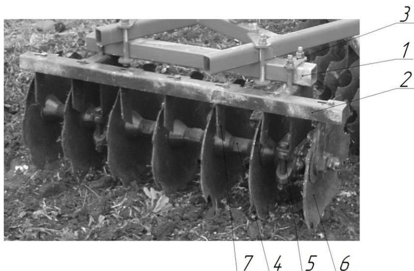
Рис.2. Составные части батареи дискатора
