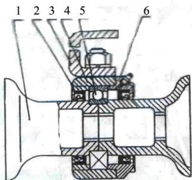
Рис. 3. Присоединительный кронштейн с корпусом подшипников
