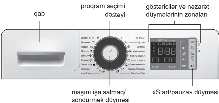
Şəkil 1 – İdarəetmə paneli
