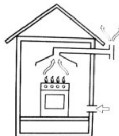
Вентиляция с помощью прямого доступа наружу
