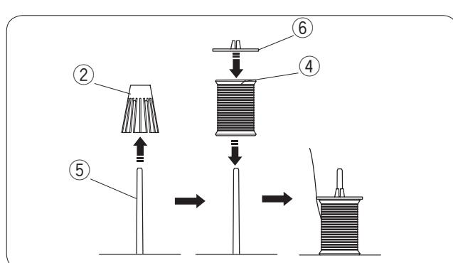
При использовании маленьких катушек снимите с катушечных стержней держатели катушек.
