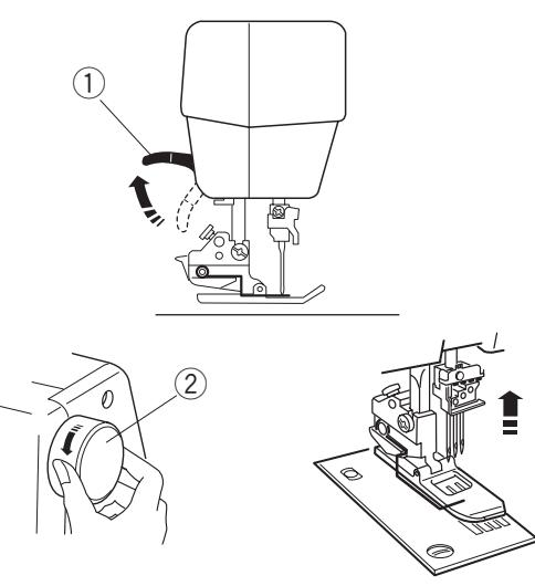
Поднимите рычаг прижимной лапки.
