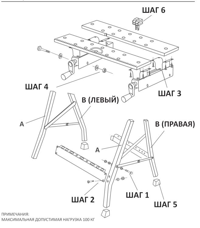
**ШАГ 1:** с помощью болтов (№ 3), шайб (№ 7) и гаек (№ 11) соедините рамы ног (№ 5).
