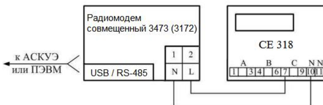
Рисунок 21. Схема подключения счетчика непосредственного включения через PLC-интерфейс
