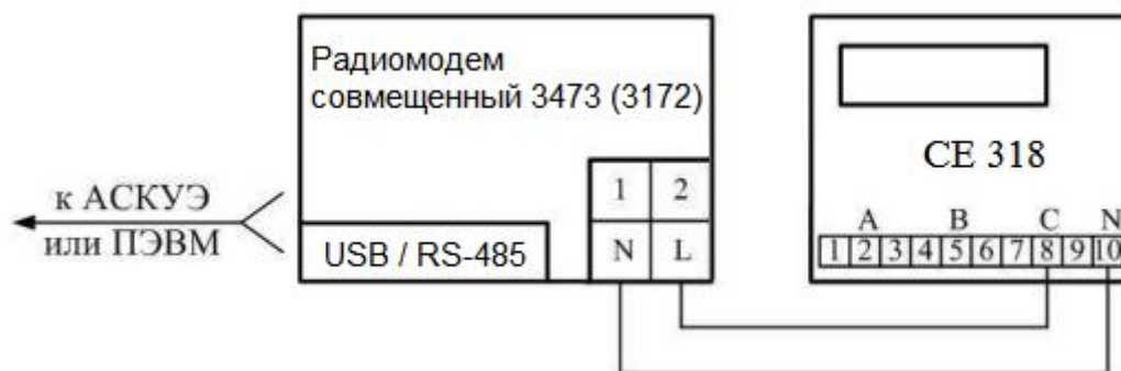
Рисунок 20. Схема подключения счетчика трансформаторного по току включения через PLC-интерфейс
