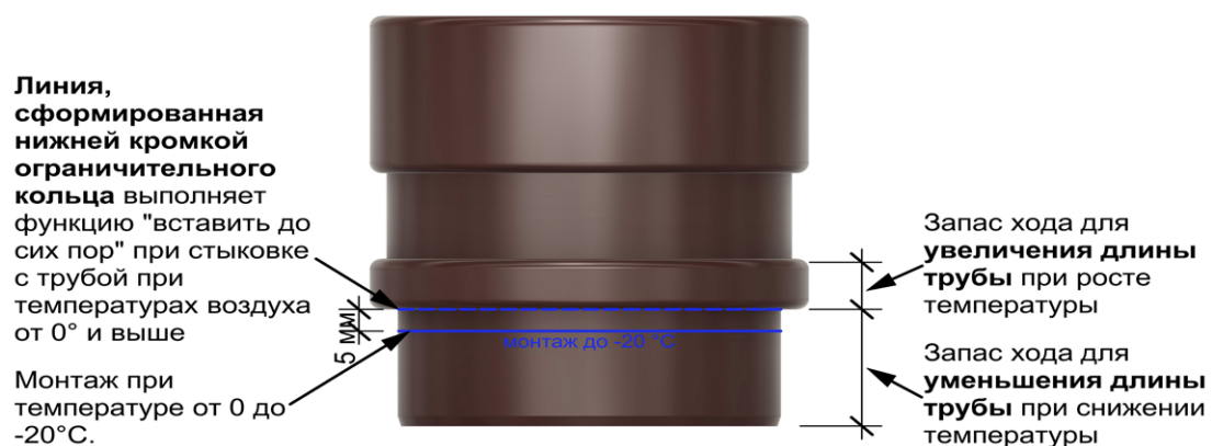
Рис. 33 Предохранительная система водоотведения на фитингах BC LUX
