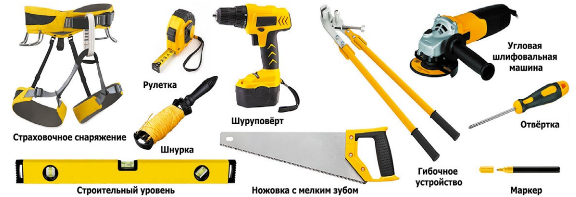
Рис. 4 Перечень инструментов монтажника
