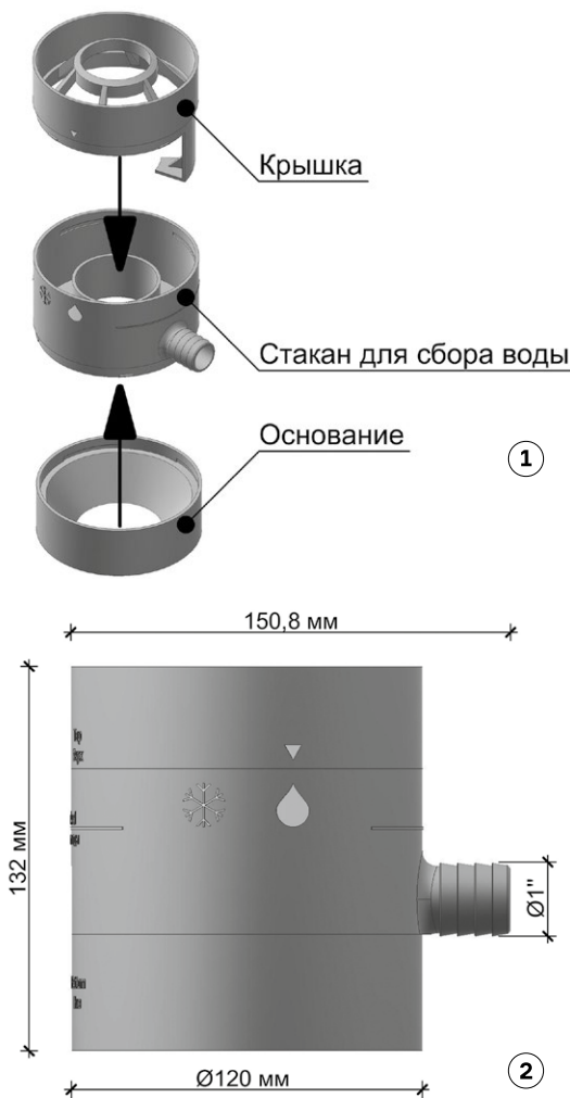
Рис. 45 Основные элементы и габаритные размеры водосборника
