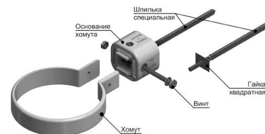
Рис. 34 Хомут LUX универсальный и шпилька с гайкой
