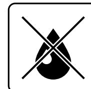
Изделие не предназначено для использования с подачей охлаждающей жидкости в место реза/шлифования
