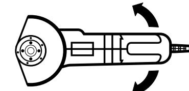
Изделие с раскручивающимся или останавливающимся диском обладает повышенным боковым крутящим моментом. Не выпускайте его из рук при запуске и выключении до полной остановки диска
