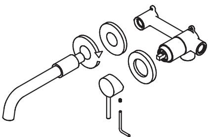
1. Подготовьте в стене нишу, согласно габаритам корпуса встраиваемого смесителя, и каналы для укладки подводящих труб. Глубина ниши должна составлять от 50 до 60 мм с учётом чистовой отделки.
