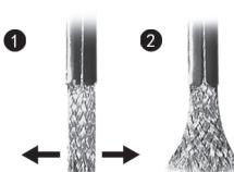
В случае спутывания контактной щетки, выпрямите ее и слегка распустите концы.
