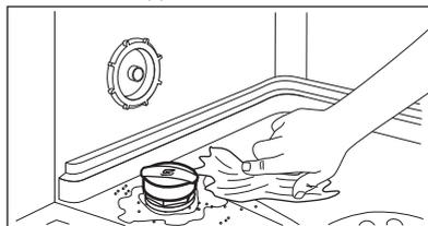
6. Чтобы закрыть емкость для соли, поверните крышку емкости для соли по часовой стрелке.
