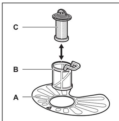
1. Поверните фильтр (B) против часовой стрелки и извлеките его.
