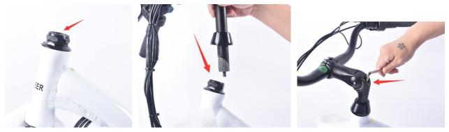
1.2 Ослабьте винт на рукоятке и отрегулируйте угол наклона руля, затем закрутите винт. Затяните шток, как показано на рисунке.
