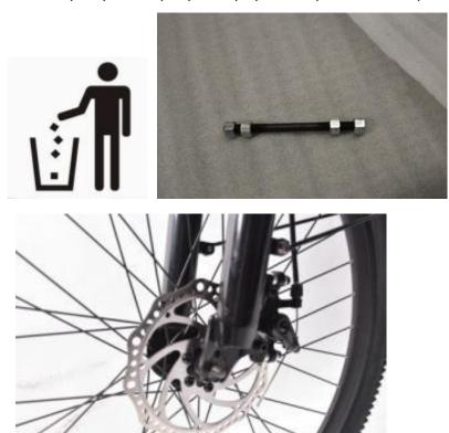
3.2 Снимите гайку и защитную шайбу с колеса, убедитесь, что переднее колесо находится на одной линии с задним колесом, затем вставьте переднюю вилку в ступицу с каждой стороны, затем выньте быстросъемный стержень и открутите его. Вставьте шпажку и затяните ее.(Быстросъемный зажим находится на том же конце, что и тормоз)).
