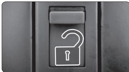
**2** Поверните на заднем торце стопор подвижной части губок в вертикальное положение (заблокировано), который не позволит подвижной губке съехать с направляющей.
