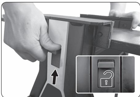
2.1 Отведите подвижную губку по направляющим в необходимых пределах, чтобы была возможность расположить между зажимными губками предмет для последующей его обработки.
