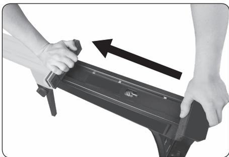
2.2 При необходимости, подвижную губку можно развернуть на 180°, вставив ее в направляющие дальним краем от неподвижной губки - это позволит зафиксировать предмет большего размера: до 960 мм.
