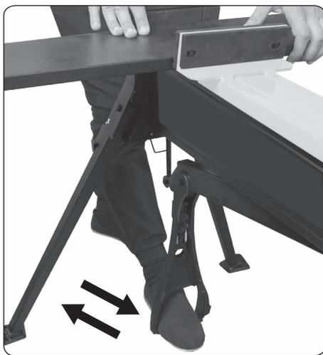
6 Переведите фиксатор блокировки/разблокировки в положение заблокировано (замок закрыт).
