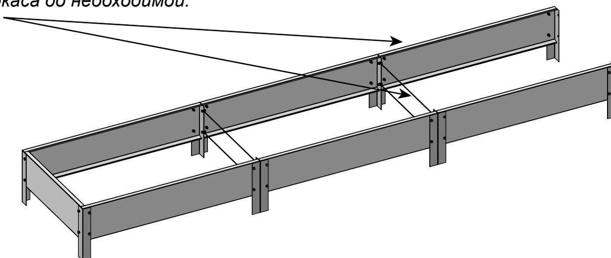
7. Установите торцевую панель на опоры между собранными боковыми панелями.
