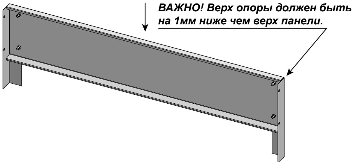
3. Установите две собранные боковые панели параллельно друг другу на необходимую ширину каркаса.
