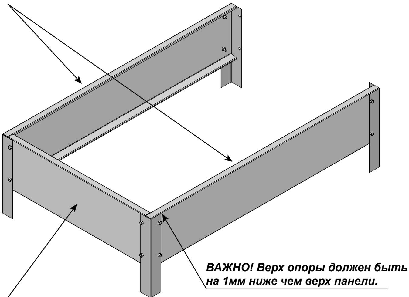
4. Устанавливаем торцевую панель. Возьмите торцевую панель и установите ее с одной стороны на опоры между двумя собранными боковыми панелями.
