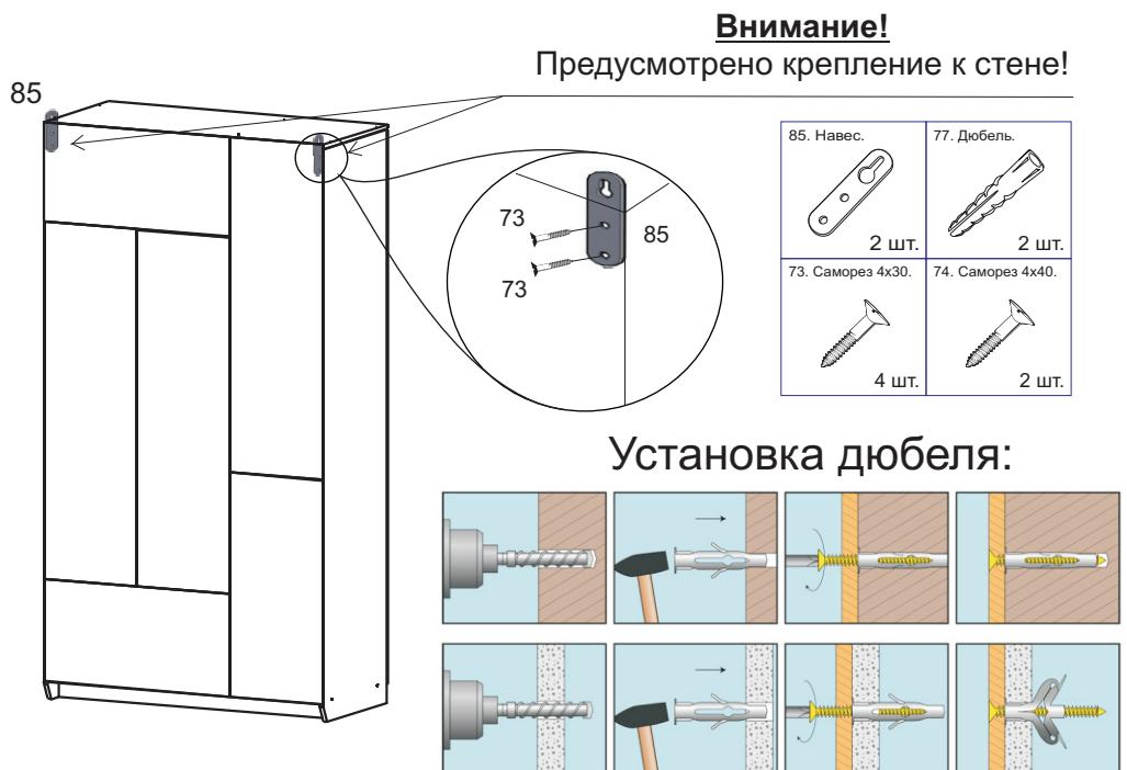
Инструкция по сборке представляет собой логическую последовательность действий с помощью которой без труда можно собрать мебельное изделие в домашних условиях.
