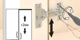
Слегка ослабить крепежные винты ответной планки. Выровнять по высоте позицию двери. Затем крепежные винты снова затянуть.
