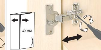
Ослабить крепежный винт и отрегулировать расстояние между дверью и боковой панелью шкафа. Затем снова затянуть крепежный винт.
