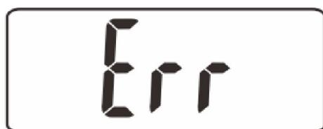
Данная индикация означает, что весы перегружены. Уберите лишние предметы и продукты с поверхности весов. Максимальная нагрузка прибора обозначена в инструкции и этикетках на его корпусе.
