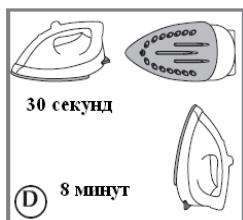
Үтікті автоматты сөндіру функциясы келесідей тәсілмен жүзеге асады: Белгілі бір температураға дейін қыздырылған, бірақ, қолданылмаған үтік, сондай-ақ, табанында жатқан немесе бір қырынан жатқан үтік 30 секундтан кейін автоматты түрде сөнеді. Егер үтік пайдаланылмаса және таяныштіректі тігінен тұрса, - автоматты түрде сөну режимі 8 минуттан кейін қосылады ( D сурет). Үтіктің автоматты отключение қызбаның индикатора жылтынымен және дыбысты құлақтандыр- (6) қоса беріледі.
