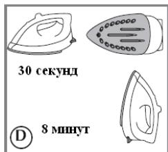
Функция автоматического выключения утюга действует следующим образом: Оставленный на подошве или опрокинутый на бок утюг, который нагрелся до определенной температуры, но не эксплуатируется, автоматически отключится через 30 секунд. Если утюг не эксплуатируется и находится на пяте-опоре в вертикальном положении - режим автоматического отключения сработает через 8 минут (рис. D). Автоматическое отключение утюга сопровождается миганием индикатора нагрева и звуковым оповещением (6).
