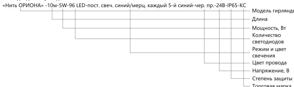
**Светодиодная гирлянда "Нить ОРИОНА"** – одна нить светодиодов (черный или белый провод), с разными типами свечения в зависимости от модели, без управления (постоянное, мерцающее, комбинированное постоянное+свечение).
