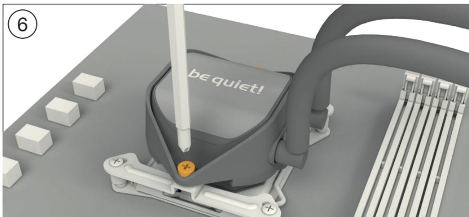
Разместите блок охлаждения процессора по центру над монтажными кронштейнами Intel и закрепите его. Для этого вы можете использовать обычную крестовую отвертку PH2. Затем подключите помпу и ARGB подсветку к концентратору ARGB-PWM.
