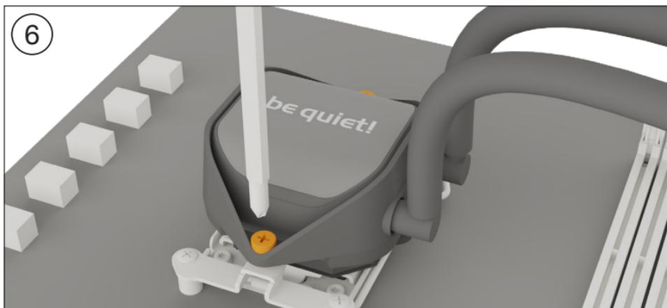
Разместите блок охлаждения процессора по центру над монтажными кронштейнами AMD и закрепите его. Для этого вы можете использовать обычную крестовую отвертку PH2.. Затем подключите помпу и ARGB подсветку к концентратору ARGB-PWM.
