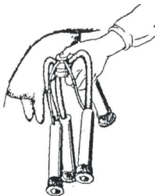
Рис. 14 Подготовка аппарата сосковой резины к надеванию на соски
