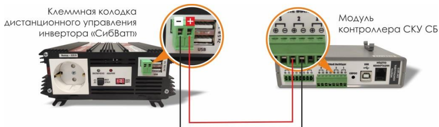
Рисунок 10 – Схема подключения к модулю контроллера SKU АБ
