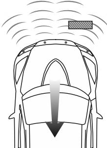
После включения заднего хода система активируется, повторно проводит самодиагностику (см. стр. 8) и работает все время, пока включен задний ход.
