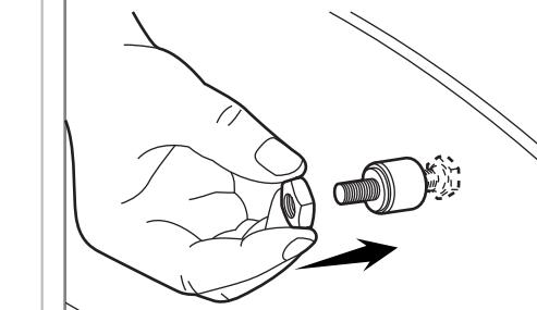
Вручную затяните гайку
