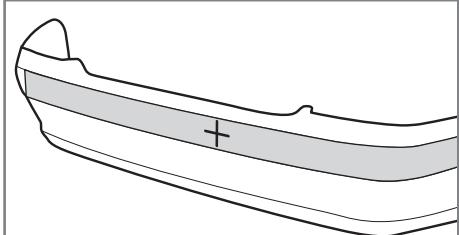
Отмерьте и отметьте точки расположения датчиков. Соблюдайте рекомендации по установке датчиков (стр. 22).
