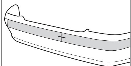
Отмерьте и отметьте точки расположения датчиков. Соблюдайте рекомендации по установке датчиков (стр. 22).
