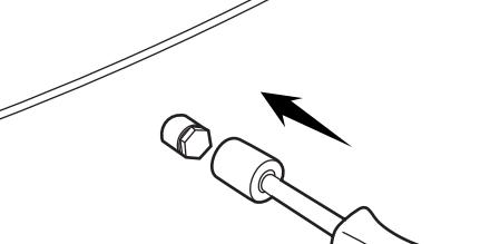
Вручную затяните гайку
