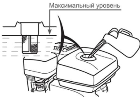
Рис. 12 Максимальный уровень топлива в топливном баке
