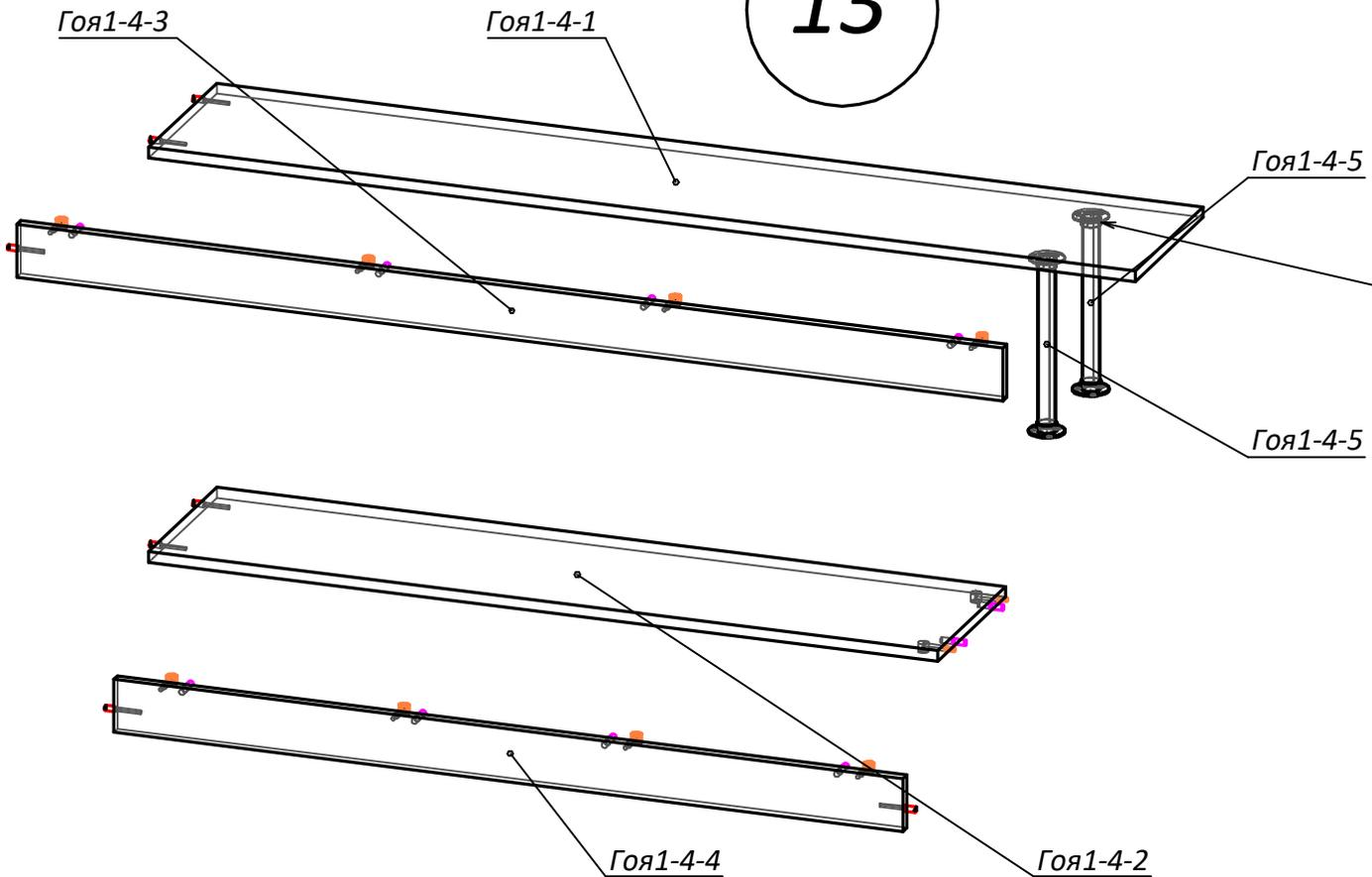
Используйте накладки на полке снизу для прикручивания держателей трубы
