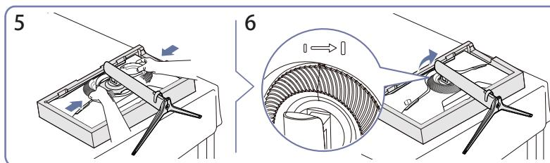
Снимите декоративную крышку. Установите декоративную крышку в направлении стрелки и поверните ее по часовой стрелке в соответствии с отметкой.
