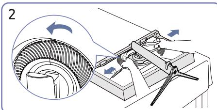
Проверните декоративную крышку против часовой стрелки и снимите ее.
