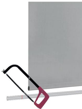
ПРИ ПОМОЩИ НОЖОВКИ ОБРЕЗАТЬ
